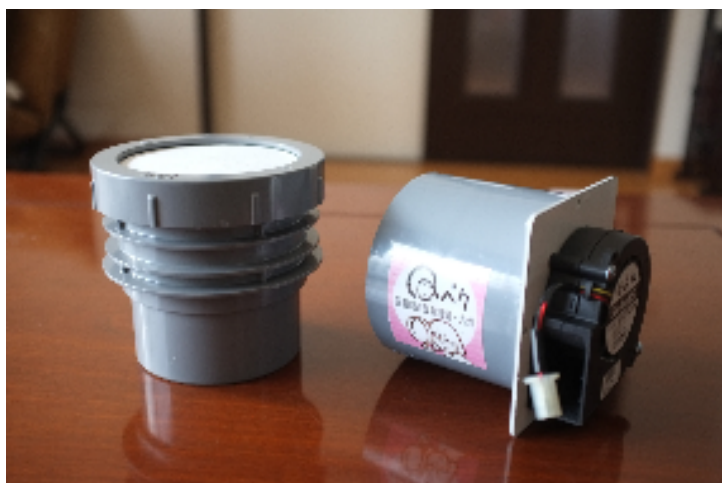
Qベク製エアーサンプラー（左の濾紙ヘッド部を右のモーター部に差込みます）
